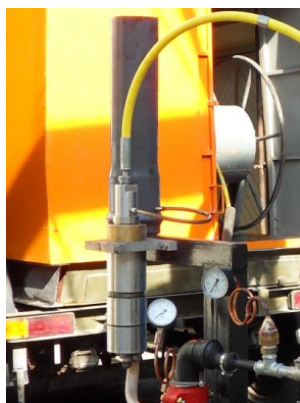
Rys. 2. Widok ogólny stanowiska badawczego do rozdrabniania materiałów
