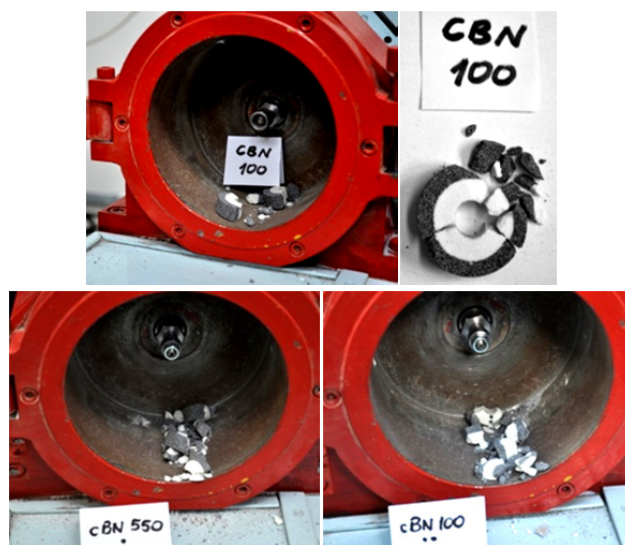
Rys.6. Zniszczenie ściernicy w wyniku rozerwania
