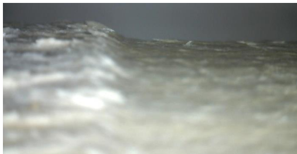
Rys. 6. Widok powierzchni drewna świerkowego po nagniataniu tocznym ( F_y = 225 N, f = 0,5 mm, n = 100 min -1 ), gdzie: a) odwarstwienia włókien drewna, b) po lewej stronie powierzchnia po toczeniu, a po prawej powierzchnia po nagniataniu (widok tej samej próbki, powiększenie 40×)
