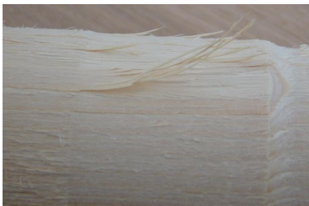
Rys. 6. Widok powierzchni drewna świerkowego po nagniataniu tocznym ( F_y = 225 N, f = 0,5 mm, n = 100 min -1 ), gdzie: a) odwarstwienia włókien drewna, b) po lewej stronie powierzchnia po toczeniu, a po prawej powierzchnia po nagniataniu (widok tej samej próbki, powiększenie 40×)
