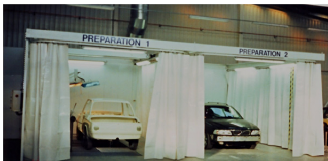
Rys. 1 Podwójne stanowisko przygotowawcze z odciąganiem bez nawiewu (fot. Techniki Systemów Aplikacyjnych Sp. zo.o.)
