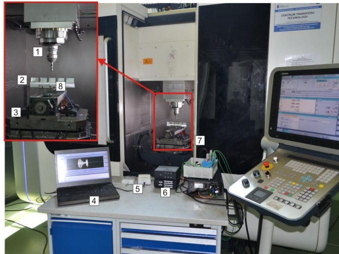
Rys. 2. Stanowisko badawcze: 1- narzędzie, 2- badana próbka, 3- platforma sił skrawania, 4- komputer, 5- przetworniki A/C, 6- sterowanie wzmacniaczy, 7- wzmacniacze ładunku, 8- czujnik drgań
