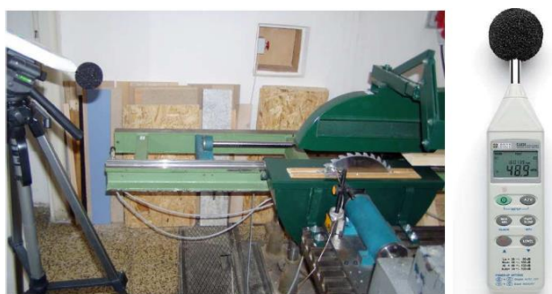
Rys. 3. Miernik poziomu dźwięku Chauvin Arnoux i jego położenie na stanowisku badawczym [3]
