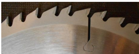
Rys. 1. Szczegół piły AS OPTICUT z nierównomierną podziałką ostrzy skrawających
