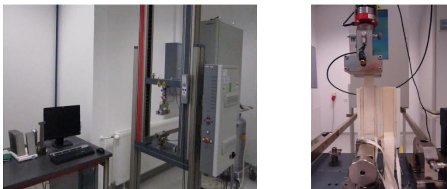
Rys. 3. Stanowisko do pomiaru adhezji, maszyna wytrzymałościowa Zwick/Roell Z005 i sposób przeprowadzenia pomiaru
