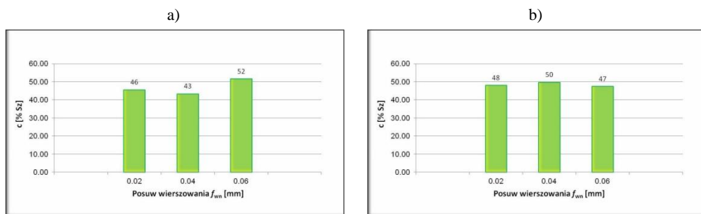
Rys. 5. Wartość poziomu odniesienia c (% Sz) dla Smc(mr)=50\% po nagniataniu tocznym ortogonalnym powierzchni krzywoliniowych wypukłych (a) oraz wklęsłych (b) w zależności od posuwu wierszowania; siła nagniatania F_n=100 N
