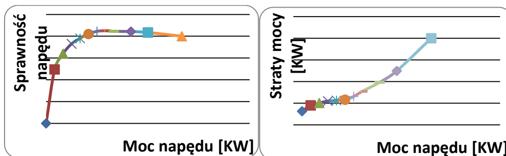
Rys. 5. Charakterystyka sprawności silnika prądu stałego o mocy znamionowej 10 kW oraz straty mocy (na podst. [19])
