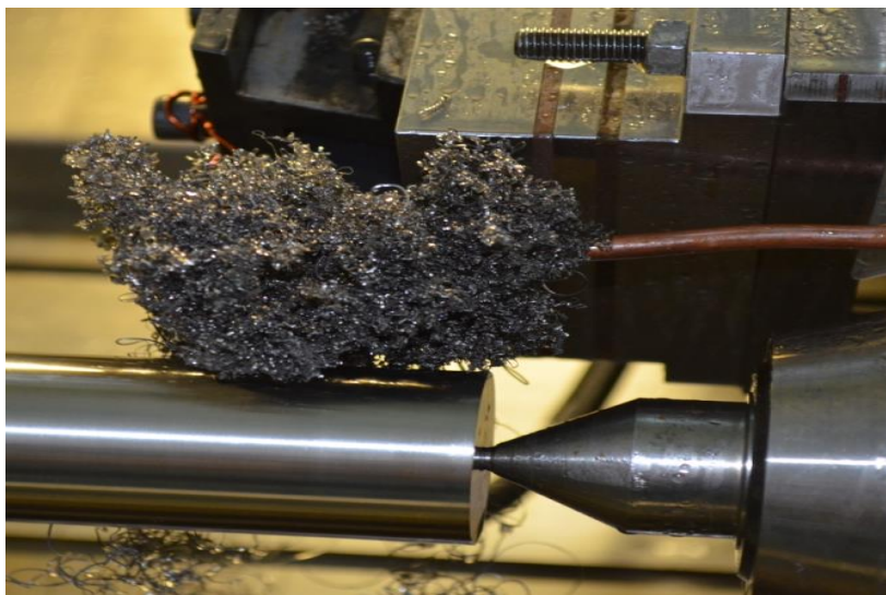
Rys. 6. Nagromadzone wióry w trakcie toczenia stopu Ti-6Al-4V z zastosowaniem chłodzenia zalewowego 0,8 MPa
