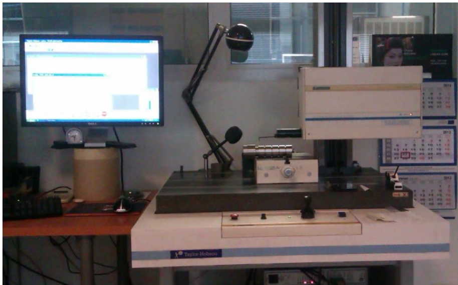
Rys. 7. Stanowisko do pomiaru chropowości – profilografometr Form Talysurf 120L
