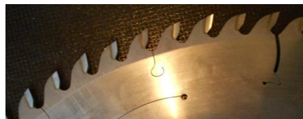
Rys. 2. Szczegół piły Pilana – prototyp z równomierną podziałką ostrzy skrawających
