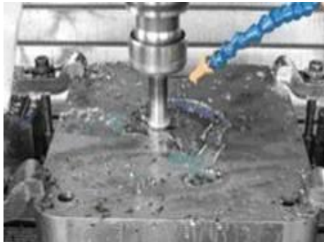
Rys. 3. Frezowanie zgrubne wkładki ruchomej
