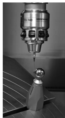
Rys. 2. System diagnostyki obrabiarek 5-osiowych: a) Axiset firmy Renishaw [1], b) Kinematics Opt firmy Heidenhain [5]
