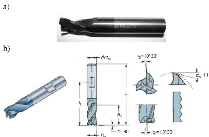
Rys. 2. Narzędzia wykorzystane w badaniach: a) frez węglkowy z powłoką TiAlN, b) frez bez powłoki o geometrii typu Kordell [21]
