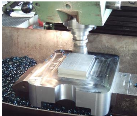
Rys. 2. Frezowanie zgrubne wkładki stałej
