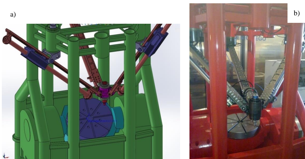
Rys. 3. Ostateczna wersja robota równoległego jako obrabiarki hybrydowej (model (a) i obiekt rzeczywisty (b)).
