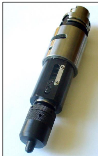
Rys. 2. Nagniatak toczny z elementem nagniatającym ceramicznym w kształcie kulki
