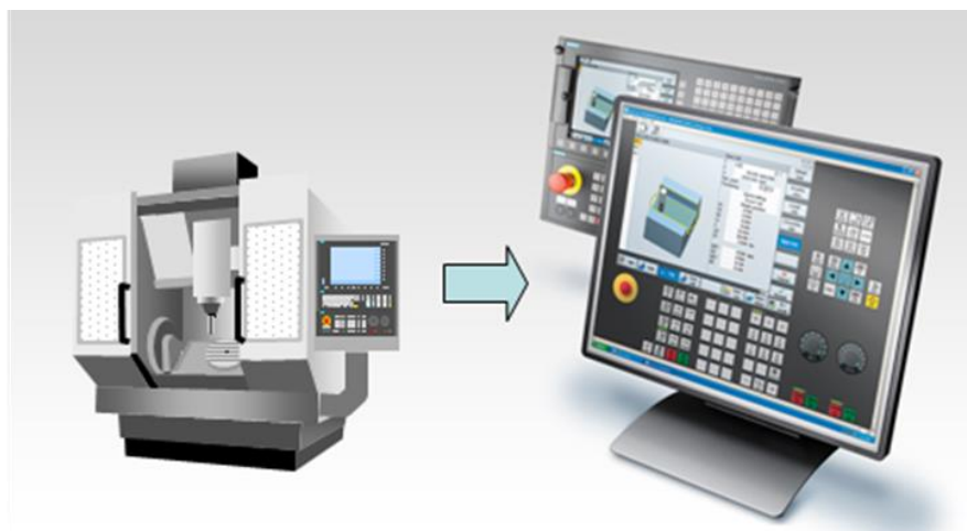
Rys. 2. SinuTrain Operate – programowy symulator działania systemów CNC SINUMERIK
