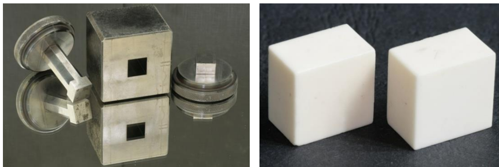
Rys. 1. Widok stalowej matrycy do formowania metoda prasowania jednoosiowego i próbek z tlenku glinu, uformowanych tą metodą
