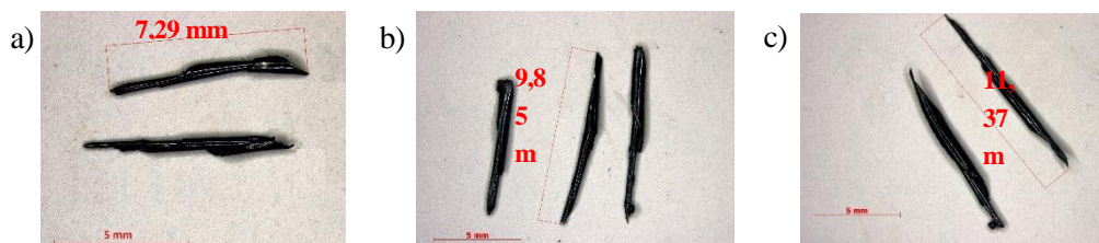
Rys. 13. Wióry powstałe podczas obróbki trochoidalnej: a) dla skoku trochoidy w=2,5\% , b) dla skoku trochoidy w=5\% , c) dla skoku trochoidy w=7,5\%
