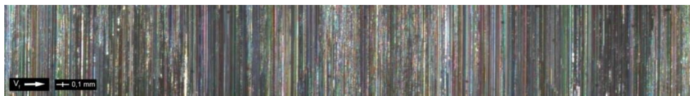
Rys. 12. Cyfrowe zdjęcie powierzchni po frezowaniu z chłodzeniem azotem ciekłym z prędkością posuwu v_f=505 mm/min
