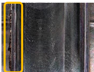
Rys. 10. Zadziory powstałe podczas obróbki konwencjonalnej
