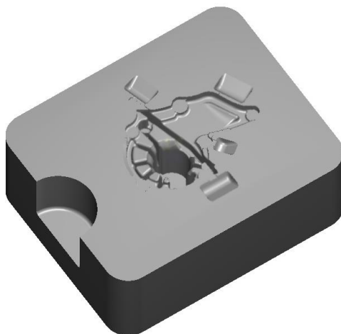
Rys. 6. Wkładka ruchoma formy ciśnieniowej
