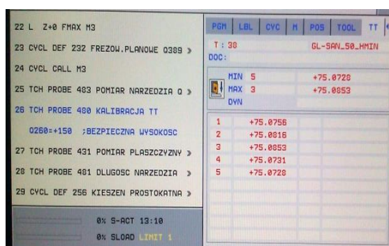
Rys. 4. Widok przykładowego pomiaru narzędzia za pomocą sondy narzędziowej TT 120 firmy HEIDENHAIN
