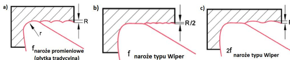
Rys. 2. Schemat powstawania chropowatości powierzchni po toczeniu ostrzami o: a) narożu tradycyjnym, promieniowym; b, c) narożu typu Wiper [4]
