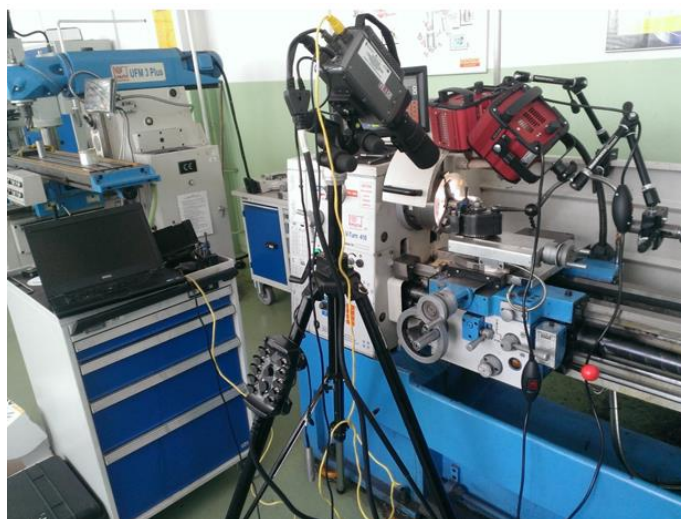
Rys. 3. Stanowisko badawcze do rejestracji procesu formowania wióra
