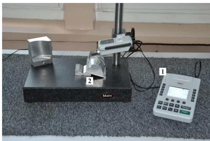
Rys. 3. Stanowisko do pomiaru chropowatości powierzchni: 1– profilometr MAHRSurf M300, 2– badany model
