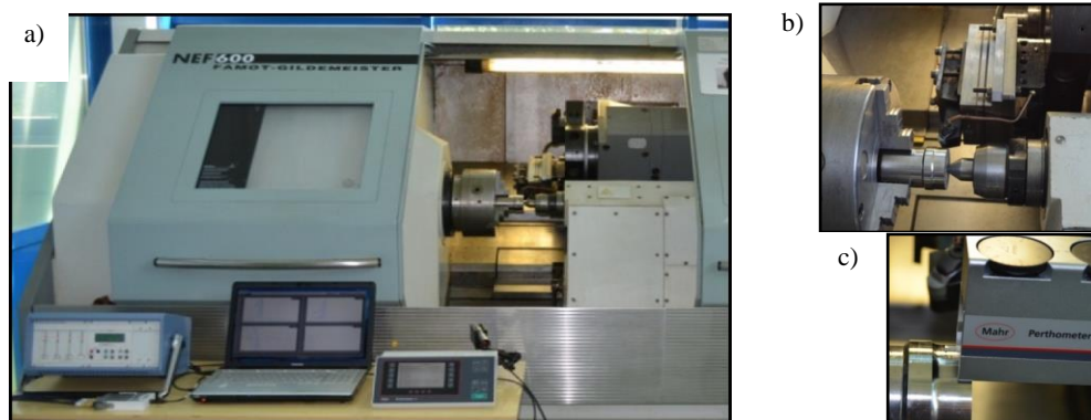
Rys. 1. Stanowisko badawcze (a), pomiar wartości składowych całkowitej siły skrawania (b), pomiar chropowatości powierzchni (c)
