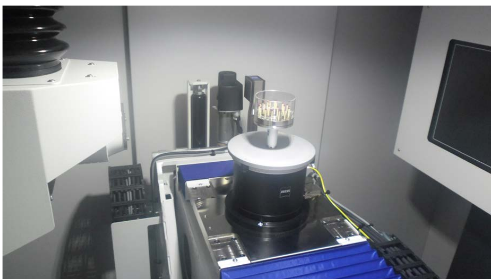
Rys. 4. Wzorzec METROTOM Check Micro wewnątrz komory tomografu.
