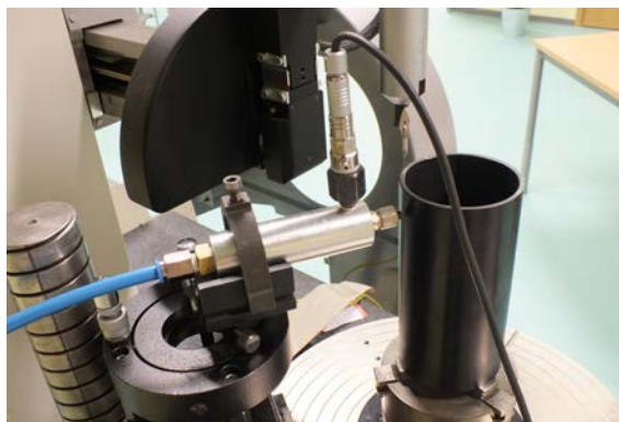
Rys. 3. Stanowisko do pomiaru odchyłki okrągłości metodą stykową i pneumatyczną
