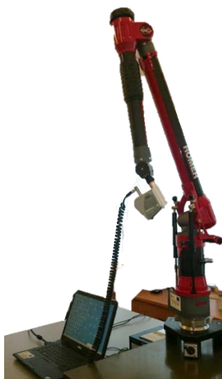
Rys. 1. Ramię pomiarowe CimCore Infinity 2.0 wraz z przystawką Perceptron v4i
