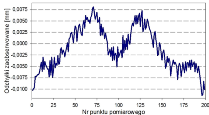
Rys. 6. Rozkład odchyłek zaobserwowanych po wstępnych pomiarach współrzędnościowych.
