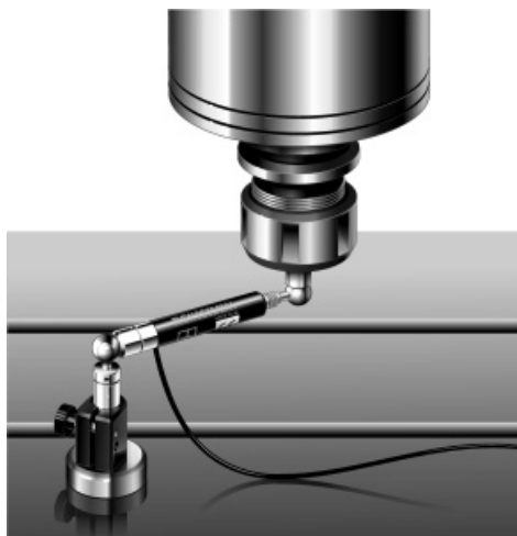
Rys 1. Urządzenie Ballbar QC10 zamontowane między stołem a wrzecionem frezarki [10]
