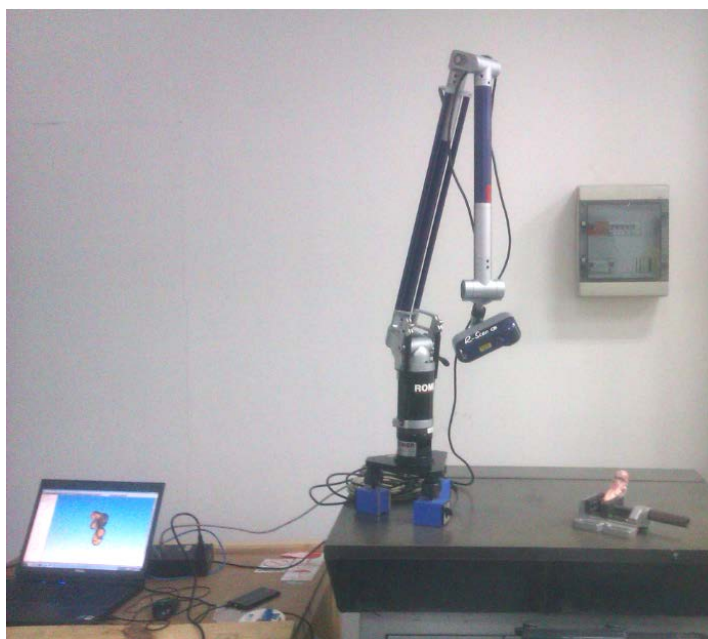
Rys.2. Stanowisko pomiarowe w skład którego wchodzi ramię pomiarowe wraz z oprzyrządowaniem
