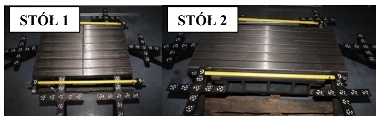
Rys. 3. Pomiary fotogrametryczne odchyłki płaskości powierzchni górnej stołów z rowkami teowymi
