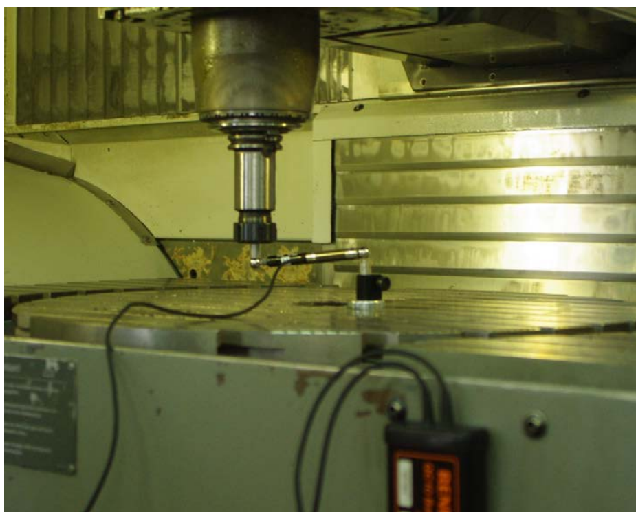
Rys. 2. Widok urządzenia Ballbar ustawionego do pomiaru błędów okrągłości i diagnostyki frezarki w płaszczyźnie XY
