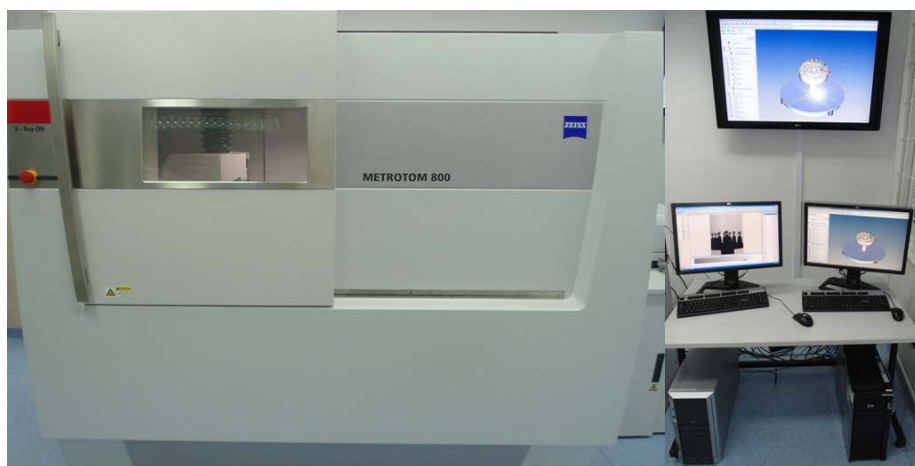
Rys. 1. Po lewej przemysłowy tomograf komputerowy METROTOM 800, po prawej komputery do rekonstrukcji i analizy danych.
