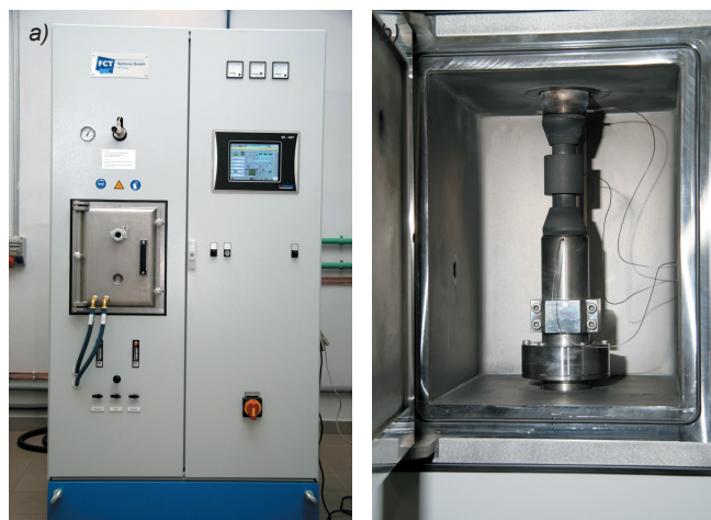
Rys. 1. Urządzenie FCT HP D 5 do spiekania metodą SPS (a); komora do spiekania (b)
