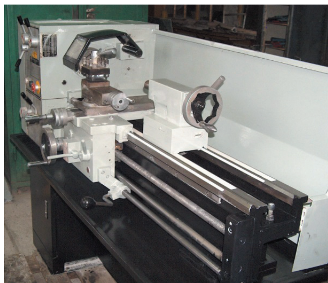
Rys. 4. Wyremontowana tokarka SPC-900 PA
