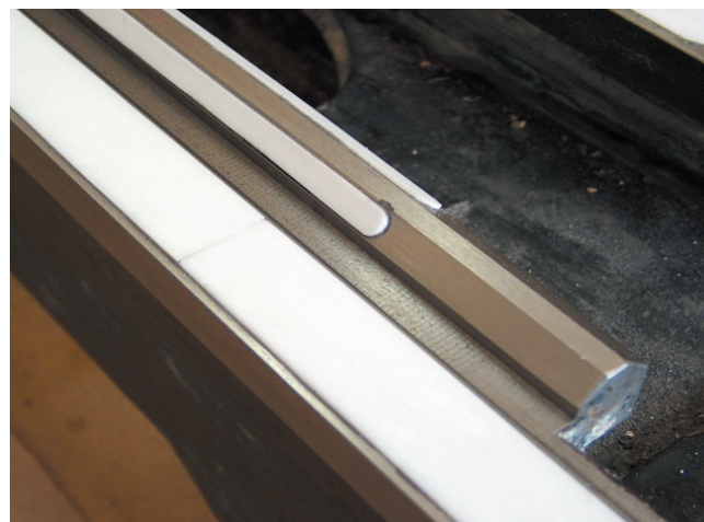
Rys. 2. Fragment łoża tokarki z wklejonymi w przewodnice kształtkami ceramicznymi
