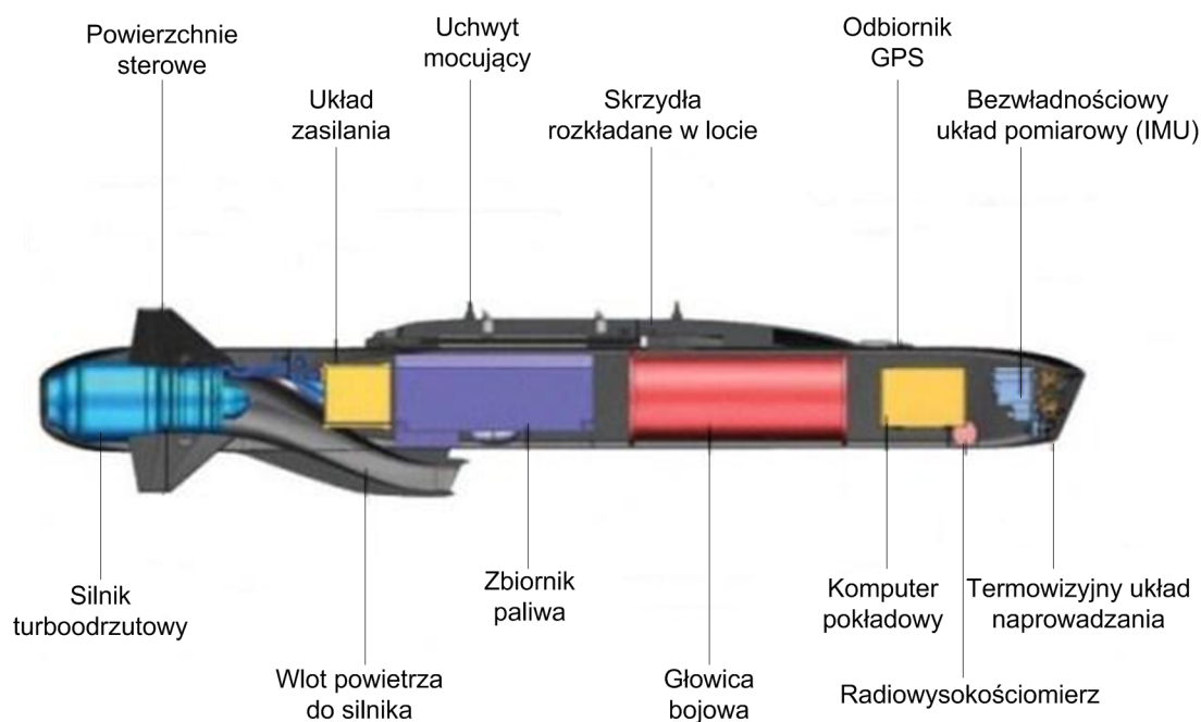
Rys. 3. Ogólna budowa pocisku manewrującego SOM (materiały firmy: TUBITAK-SAGE)
