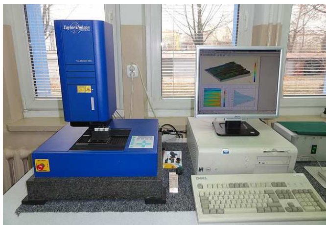
Rys. 3. Widok stanowiska pomiarowego Talyscan 150 do pomiarów topografii powierzchni
