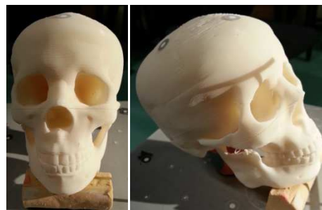
Rys. 5. Model czaszki wydrukowany w technice FDM na podstawie pomiarów skanerem optycznym
