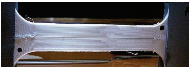
Rys. 2. Układ linii drukowania próbki B01 oraz jej wady
