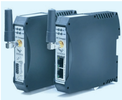
Rys. 8. Inteligentny transponder danych IoT/chmura DataEagle 7050 firmy Schildknecht [12]
