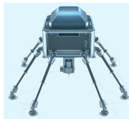
Rys. 1. Model koncepcyjny mobilnej frezarki Picum One [1]
