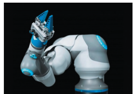
Rys. 10. BionicCobot – robot współpracujący produkowany przez firmę Festo [14]
