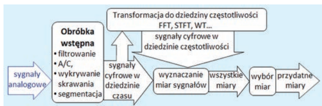
Rys. 2. Ogólny schemat przetwarzania sygnałów w DNiPS
