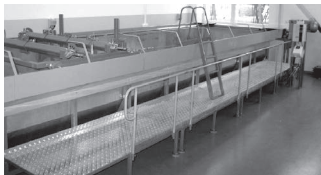
Rys. 1. Kanał glebowy w Katedrze Maszyn Rolniczych i Leśnych SGGW w Warszawie [6]
