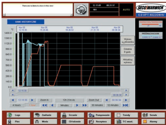
Rys. 1. Przebieg obróbki cieplnej płytek ze stali szybko tnącej w piecu próżniowym SECO/WARWICK typu 6.0VPT-4022/24IQHV: linia czerwona – temperatura; linia seledynowa – ciśnienie
