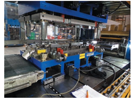
Rys. 5. Widok tłoczni zabudowanej w prasie korbowej wraz z dodatkowym oprzyrządowaniem
