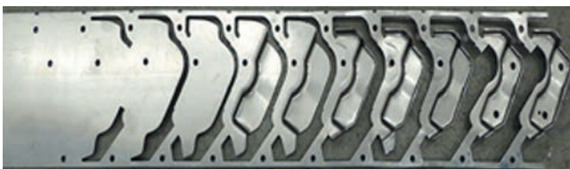
Rys. 4. Widok z góry pasa blachy z wytłoczką po kolejnych operacjach
