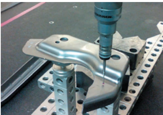
Rys. 9. Przestrzeń robocza maszyny pomiarowej w trakcie prowadzonych pomiarów odchyłek wymiarowych wytłoczki
