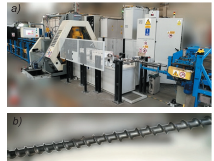
Rys. 4. Automatyczna linia technologiczna do walcowania gwintów na gorąco (a) i gotowy wyrób (b)
