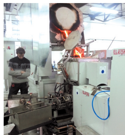
Rys. 8. Linia odlewania ciągłego
