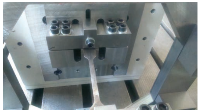
Rys. 6. Próbką zamocowana na stanowisku
