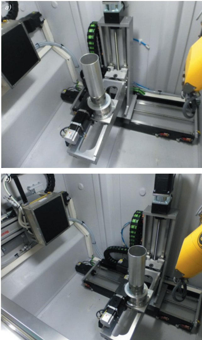
Rys. 2. Tuleja podczas pomiaru na tomografie GE Phoenix v|tome|x s240: a) pojedyncze położenie detektora – obiekt oddalony od źródła promieniowania, b) ruch detektora zapewniający dwukrotnie większe powiększenie obrazu – obiekt bliżej lampy rentgenowskiej
