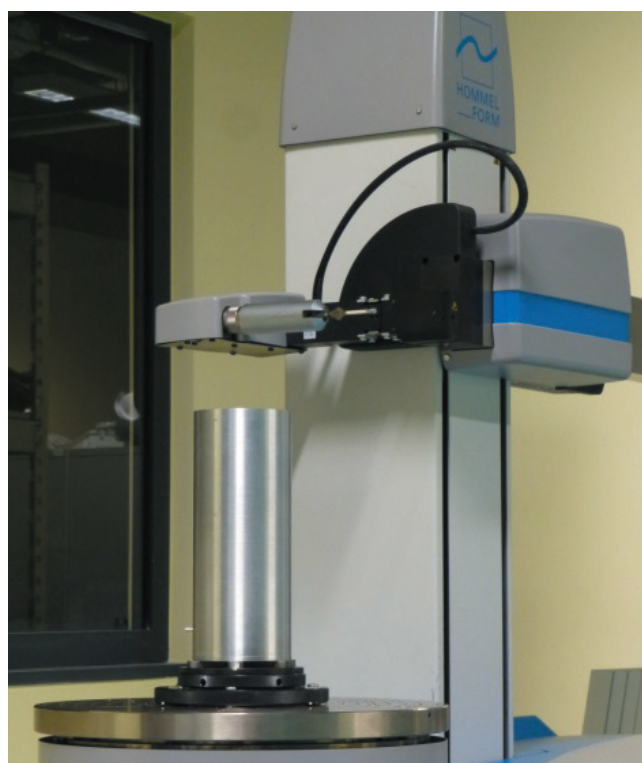
Rys. 1. Okrągłościomierz Jenoptik Hommel Roundscan 535 z mierzoną tuleją (laboratorium ZMiSP)
