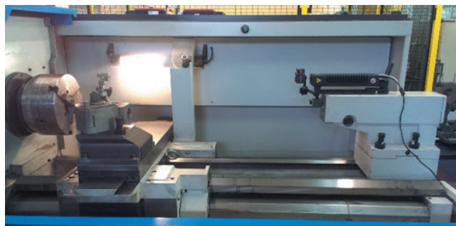
Rys. 1. Zamocowanie interferometru na obrabiarce
