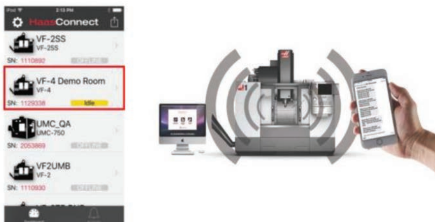
Rys. 7. HaasConnect – idea i wygląd ekranu zdalnego monitorowania stanu obrabiarki (źródło: int.haascnc.com)
