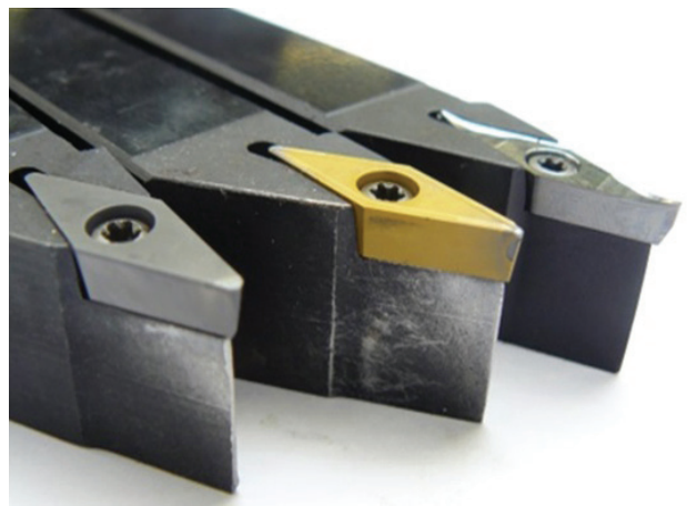
Rys. 8. Widok ostrzy noży tokarskich po badaniach nacinania zwoju ślimaka
