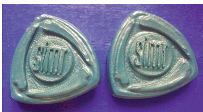
Rys. 8. Wygląd wyprasek z testów nr 2 po zmianie granulatu
