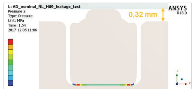
Rys. 5. Ciśnienie w kontakcie w krytycznym obszarze uszczelnienia
