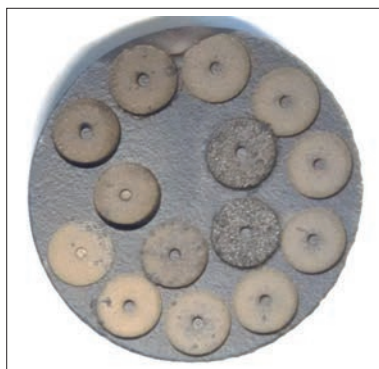
Rys. 6. Próbkę z kompozytu Al_2O_3-Ti(C,N)-TiB_2 z wydrążonymi wgłębieniami
