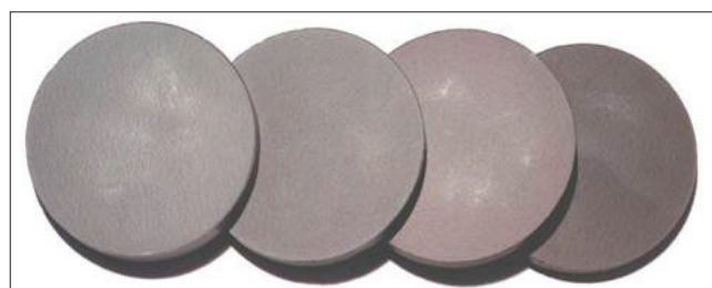
Rys. 4. Próbkę materiałów ceramicznych do obróbki EDM po spiekaniu metodą SPS
