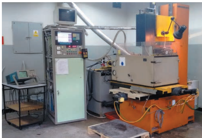
Rys. 5. Doświadczalna drążarka elektroerozyjna EDEF-40
