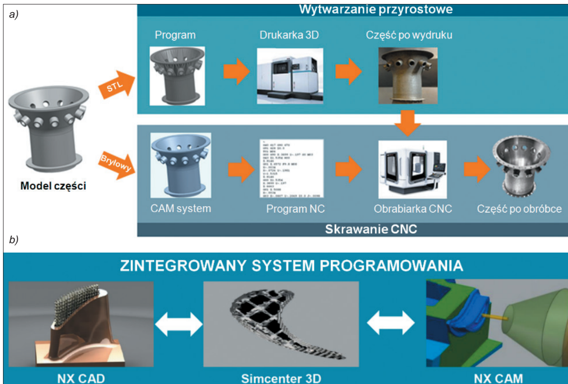
Rys. 5. Ogólna koncepcja integracji (a) i kompletnego programowania (b) obróbki przyrostowej i ubytkowej (AM + CNC) według firmy Siemens [4]
