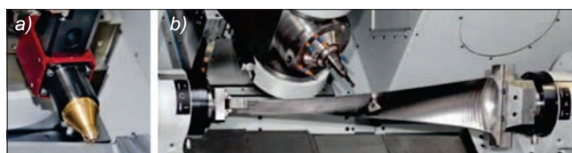
Rys. 17. Napawanie krawędzi (a) i frezowanie łopatki turbiny po napawaniu (b) [21]
