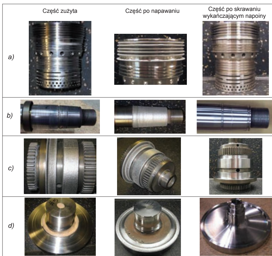
Rys. 19. Przykłady naprawy różnych wyrobów z użyciem techniki LDT [18]: a) naprawa obudowy sprężarki gazowej (materiał: Inconel 718), b) naprawa wału ze stali 4340 (materiał napawany: stal odporna na korozję 420 LC), c) naprawa łącznika przekładni planetarnej (materiał napawany: stal odporna na korozję 420 LC), d) uzupełnienie materiału na wybrakowanej odkuwce ze stopu tytanu Ti6-4
