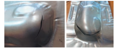
Rys. 1. Wytłoczka z wadami w postaci pęknięć i zmarszczek
