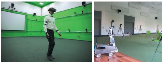
Rys. 2. Ruch osoby biorącej udział w badaniach (z lewej) zostanie przeniesiony na odpowiedni ruch robota w sąsiedniej sali (z prawej)
