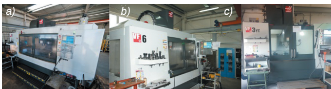
Rys. 2. Badane centra frezarskie: a) VF-7/50, b) VF-6/50, c) VF-3YT/50
