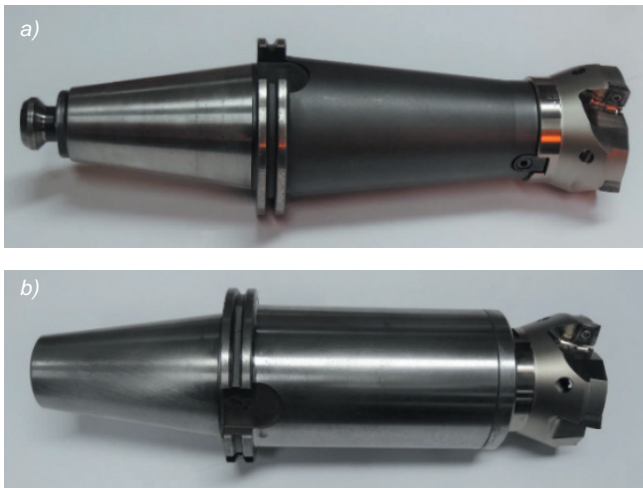
Rys. 2. Narzędzia skrawające: a) narzędzie standardowe, złożone z oprawki TC50H160D27E i głowicy Mitsubishi ASX 400 08 B04 R; b) narzędzie specjalne, złożone z oprawki FNF5-01-90 i głowicy Mitsubishi ASX 400 08 B04 R
