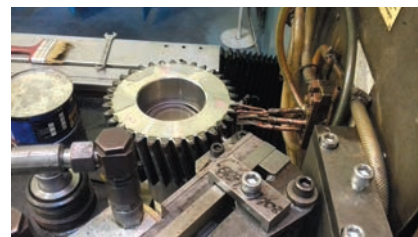
Rys. 2. Operacja hartowania indukcyjnego kół zębatach w warunkach przemysłowych
