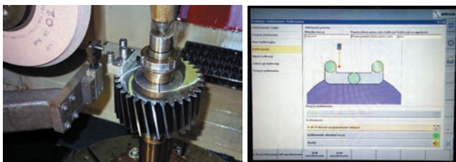
Rys. 4. Kalibracja opuszczalnego zewnętrznego ramienia pomiarowego na szlifierce Rapid Höfler 900
