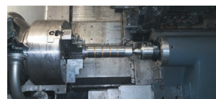
Rys. 2. Toczenie próbki na tokarce CTX 310 ECO
