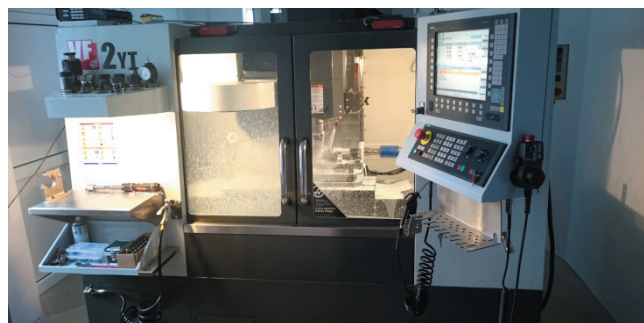
Rys. 1. Zautomatyzowane stanowisko diagnostyczne procesów szlifowania [4]
