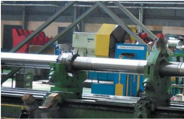
Rys. 1. Sposób podparcia risera podczas procesu obróbki tokarskiej
