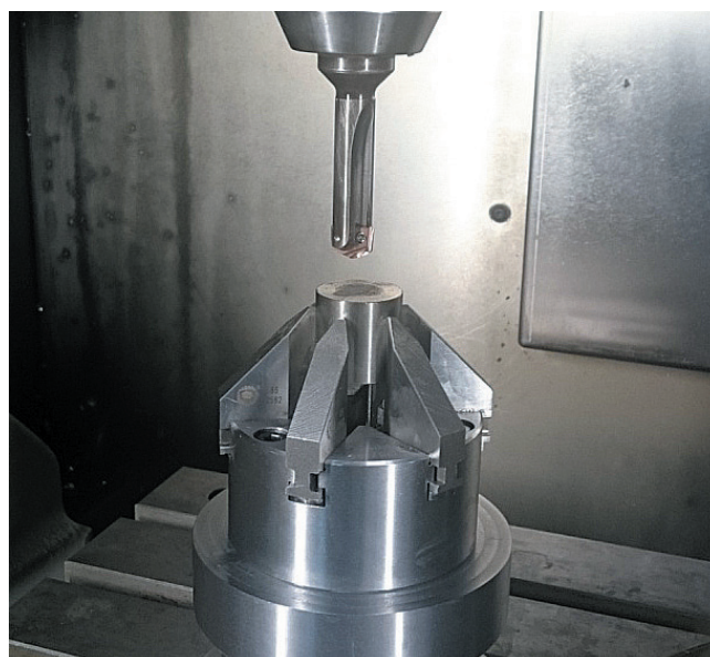
Rys. 1. Stanowisko do pomiaru momentu i siły skrawania podczas wiercenia
