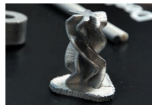
Rys. 5. Przykładowy element demonstracyjny, wykonany techniką MFDM
