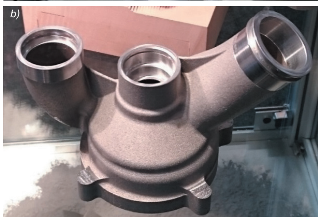
Rys. 3. Elementy lotnicze (a) i samochodowe (b) z precyzyjnie obróbnymi kołnierzami
