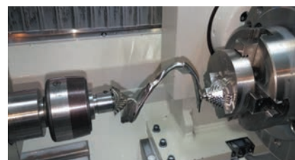
Rys. 3. Układ obróbkowy z przyrządem i przedmiotem (obróbka wykończeniowa)
