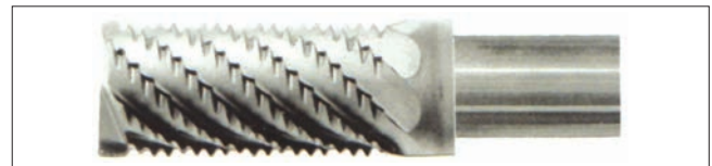
Rys. 13. Frez trzpieniowy z powłoką diamentową o schodkowo zbudowanych krawędziach, do obróbki materiałów kompozytowych (Prototyp-Werke)
