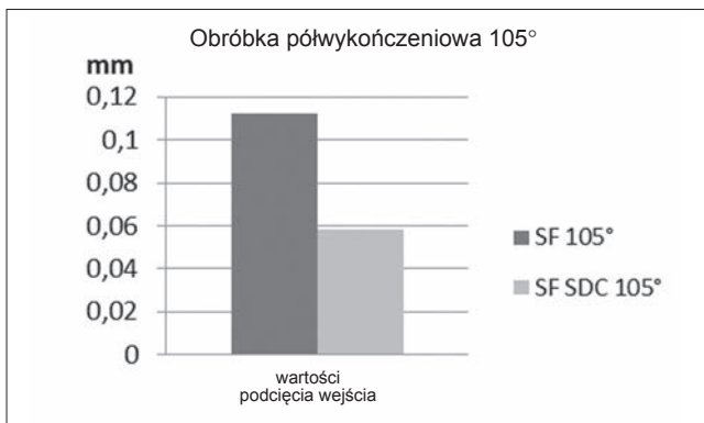
Rys. 6. Porównanie obróbki wykończeniowej z stałą prędkością posuwu i ze zwalnianiem posuwu w narożach, dla kąta 105°
