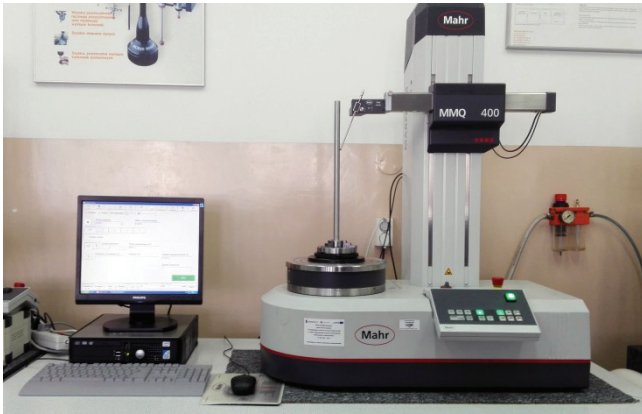
Rys. 6. Pomiar odchyłki walcowości przedmiotu na okrągłościomierzu MarForm MMQ 400
