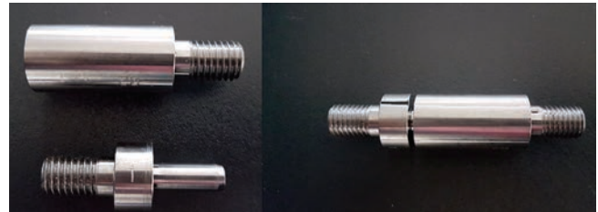
Rys. 1. Wałek i oprawa przed złożeniem i po złożeniu
