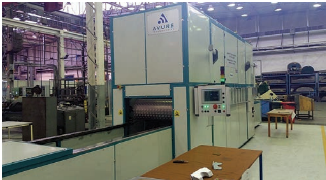
Rys. 3. Przemysłowa prasa tunelowa Avure wykorzystywana w procesie tłoczenia narzędziami elastycznymi
