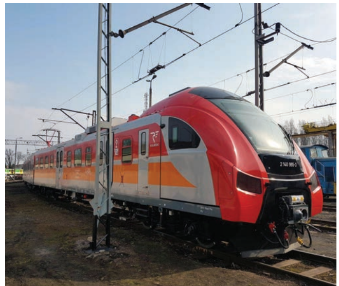
Rys. 8. Czołówka EZT ED72 po modernizacji w ZNTK Mińsk Mazowiecki
