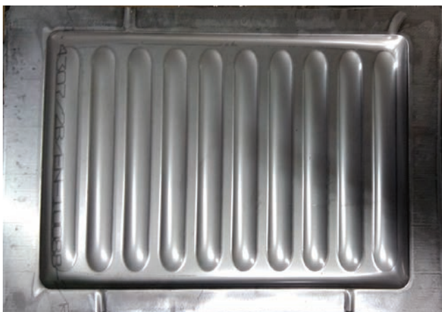
Rys. 7. Panel zbiornika wytworzony metodą formowania elastycznym stemplem
