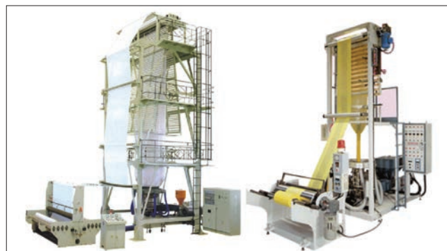
Rys. 2. Przykład linii technologicznych do produkcji folii metodą wytłaczania z rozdmuchiwaniem pionowo w górę [18, 19]
