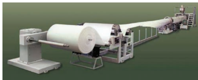
Rys. 1. Linia do wytłaczania folii porowatej firmy IMG-Plastec – wytłaczanie z rozdmuchiwaniem swobodnym poziomo [14]
