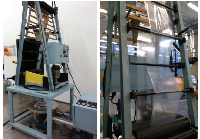
Rys. 3. Stanowisko technologiczne wytłaczania z rozdmuchiwaniem folii podczas wytwarzania jednowarstwowej
