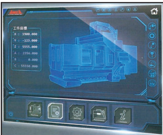
Rys. 4. Panel główny sterownika A/LINC [12]
