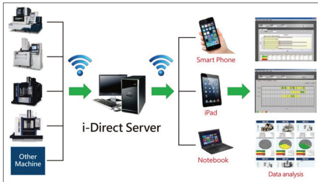
Rys. 11. Konceptcja działania systemu e-Direct Server firmy Excetek [16]
