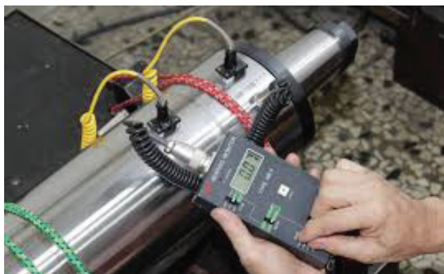
Rys. 1. Kontrola czujników wbudowanych we wrzeciono [8]
