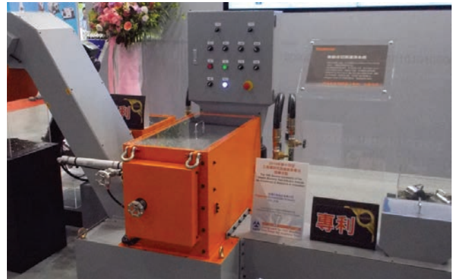
Rys. 13. Inteligentny system transportu wiórów firmy Keyarrow
