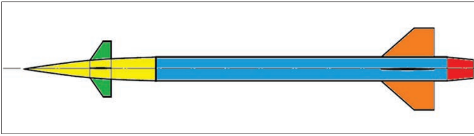
Rys. 2. Optymalizacja kształtu rakiety przeciwlotniczej dla opływu nadźwiękowego ( n=3 oraz k = \frac{4}{\sqrt{M^2-1}} , C_f – współczynnik tarcia płaskiej płytki zależny od liczby Reynoldsa)
