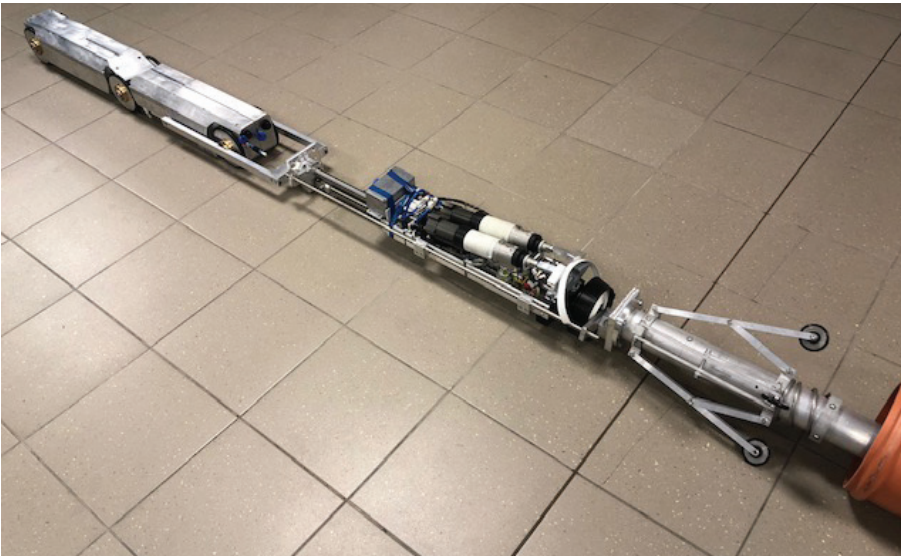
Rys. 5. Konfiguracja rzeczywistego demonstratora dla średnicy rury 200 mm wraz z nosicielem modułu technologicznego i modułem technologicznym
