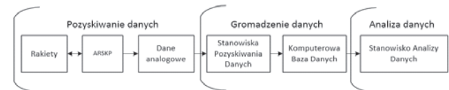
Rys. 1. Schemat blokowy systemu akwizycji i przetwarzania wyników okresowej kontroli stanu technicznego rakiet przeciwlotniczych [2]
